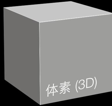
CT 扫描的关键是体素。当 X 射束的高能量光子穿过目标时，其中的一部分被吸收，另一部分散射，但剩下的会击中 X 射线源对面的探测器屏幕。它们随后按照被扫描材料的密度、厚度和衰减值的比例给（二维）像素增加能量，并生成一系列灰度图像。随后，这款软件将数以百万计的像素重建为三维体素，从而为被扫描的对象构造出完全三维的可视化。为了得到测量结果、找出缺陷、创建网格，或者执行模拟，您还需要 Volume Graphics 提供的高级分析与可视化软件。
